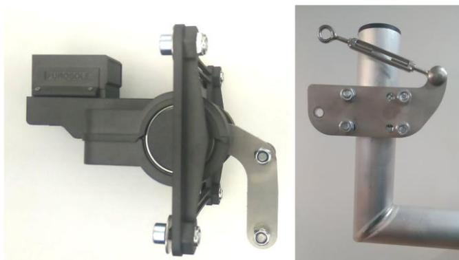
Installare la flangia sagomata sulla staffa tramite i 4 dadi (chiave 13) e connettere il corpo motore alla flangia tramite i due relativi bulloni (M8). **Attenzione:** effettuare tutte le operazioni di assemblaggio con il dispositivo spento (quando Lucilio è operativo ruota i suoi assi per trovare il corretto orientamento in funzione della sua posizione che, se non corretta, potrebbe portarlo ad angolazioni anomale).
