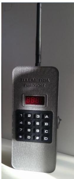
Opzionalmente è possibile utilizzare, a corredo dell'eliostato **Lucilio**, un radiocomando che ne permette il controllo a distanza.
